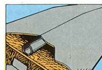
底板一体構造 ボート本体の底布にエアチューブを固定、さらに底板の一部を固定。底板のズレを防止し滑らかな走行を保障。
