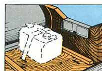
ガソリタンク固定ベルト・ホール 高速走行にも安心してスピードを維持できるように、ガソリタンクを確実に固定するベルト・ホールを採用。
